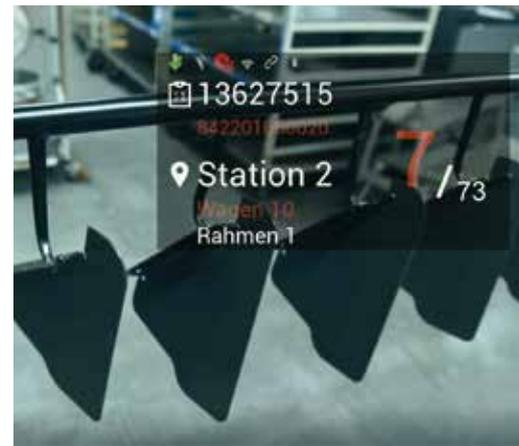
Die Sicht durch die Brille erweitert die Informationen des Werkers. Die Brille unterstützt in der Kommissionierung bei der Fertigung.
