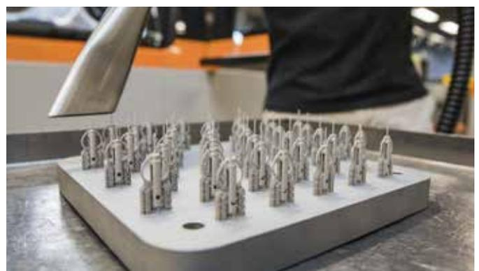
3D-Druck mit Kupfer: Prototypen und Kleinserien aus niedriglegiertem Kupfer eröffnen durch 3D-Druck eine neue Welt für Bauteile.
