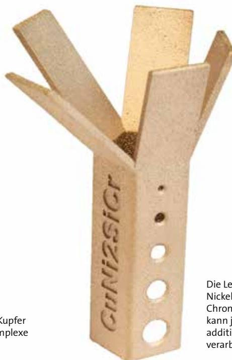
Die Legierung Kupfer-Nickel-Silizium-Chrom (CuNi2SiCr) kann jetzt mittels additiver Fertigung verarbeitet werden
