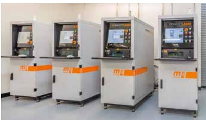
Mit Hilfe von direktem Metall-Lasersintern kann Kupfer für die additive Fertigung genutzt werden.
