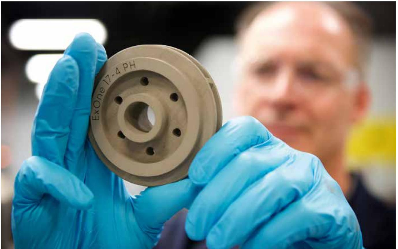
Das Laufrad ist ein im Binder Jetting Verfahren hergestellter Grünkörper. Dieser Grünkörper muss im Anschluss an den Druck im Sinterofen gebrannt werden. Im Binder-Jetting-Verfahren können sechs Materialien verarbeitet werden.
