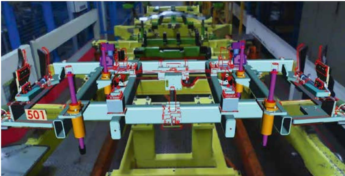
In der AR-Visualisierung werden reale Bauteile durch digitale Modelle überlagert, um Soll-Ist-Abweichungen zu identifizieren.
