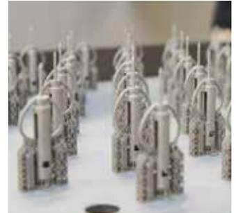
Prototypen und Kleinserien aus niedriglegiertem Kupfer eröffnen durch 3D-Druck eine neue Welt für Bauteile.
