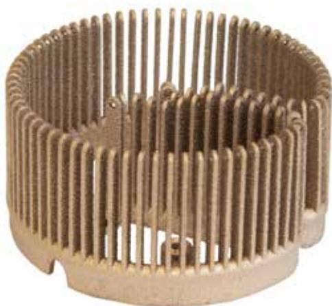
3D-Druck mit Kupfer ermöglicht komplexe Geometrien.
