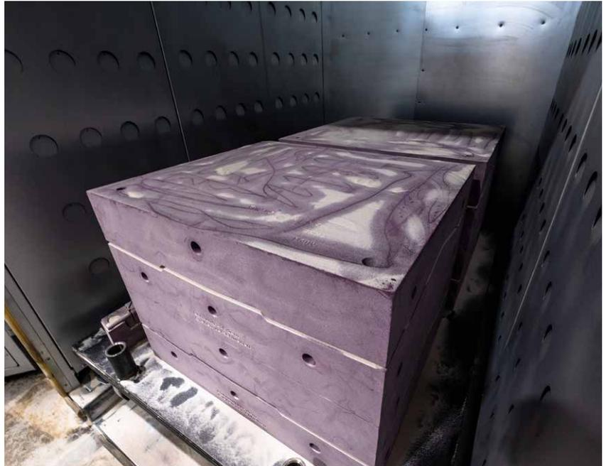
Gedruckte Formen beim Aushärten. Die gewünschten Bauteile werden immer größer.
