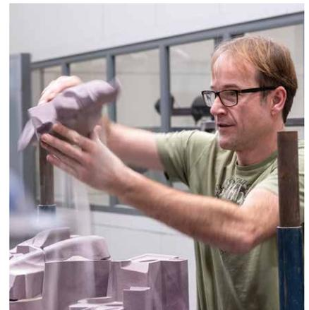
Klein-Hitpass demonstriert das mühelose Entsanden von Kernen nach dem Druck. Möglich macht das der eingesetzte Phenol-Kaltharz binder von ASK Chemicals.
